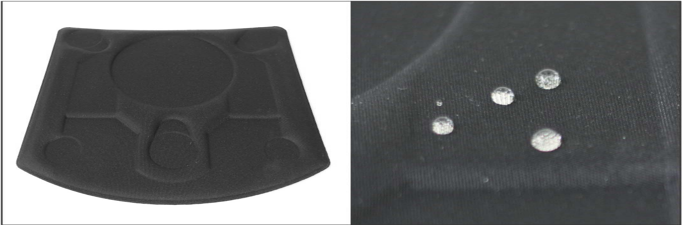
Bild 22 Multifunktionales Bauteil: Unterlage, Detailaufnahme Oberfläche. Funktionen: Luftschallabsorption, Körperschallentkopplung, diverse Zusatzfunktionen (hydrophobe Oberfläche etc.).
