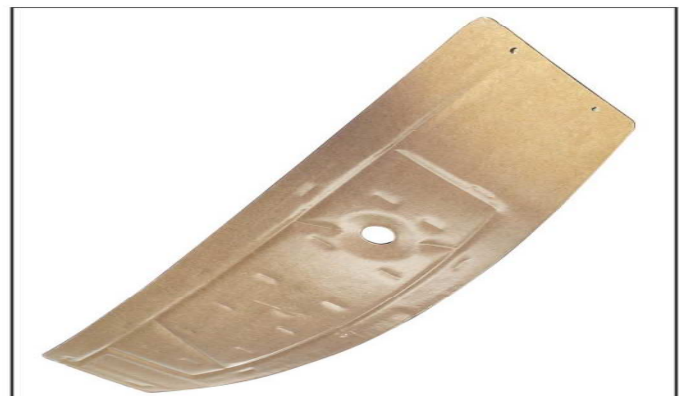
Bild 21 Thermogeformte Versteifung mit Selbstklebung auf der Rückseite. Funktionen: Strukturelle Versteifung von Blechen, Verringerung der Luftschallabstrahlung.
