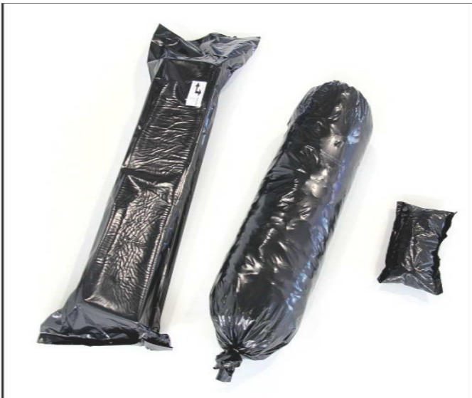
Bild 13 Mit Stanzteilen oder Schaumflocken gefüllte Beutel, komprimierbar bzw. evakuierbar. Funktionen: Bedämpfung von Hohlraumresonanzen (z. B. Technikraum), Dämmung von Luftschallgeräuschpfaden (z. B. in Kanälen).
