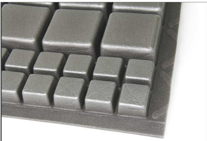
Bild 14 Vakuumformteil aus PE-Schaum als Luftschallabsorber. Funktionen: Wasser-/Dampfdichte Abdichtung, Luftschallabsorption (durch Kästchenabsorber), wasser-/dampfdichte Abdichtung.
