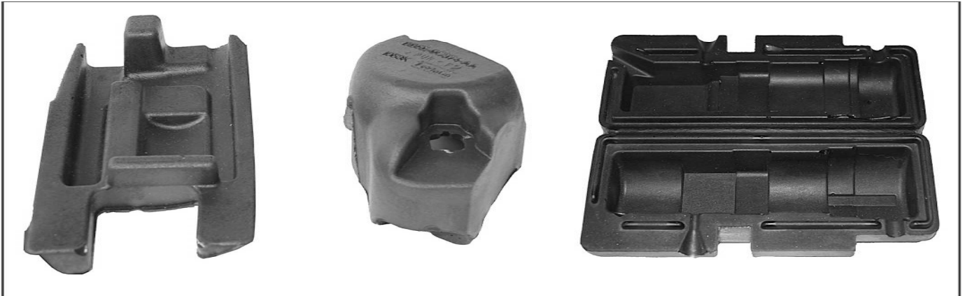
Bild 8 Polyurethan-Formschaumteile (Beispiele: Lagerung, Abdeckung, Kapsel). Funktionen: Luftschalldämmung, Körperschallentkopplung, thermische Isolation, weitere Funktionen durch Formgebung.
