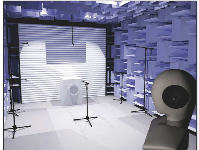
Bild 4 Prinzipieller Messaufbau im schallreflexionsarmen Messraum: Bestimmung des Schalleistungspegels einer Waschmaschine, Mikrofonaufstellung, Kunstkopf-Messsystem.
