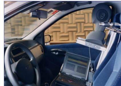
Kunstkopfmessungen im Fahrzeuginnenraum
